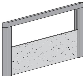
pannellatura ad incastro fra i pilastri con finestratura a nastro
