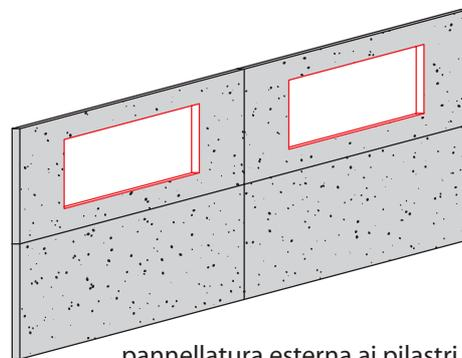
pannellatura esterna ai pilastri con finestratura a nastro
